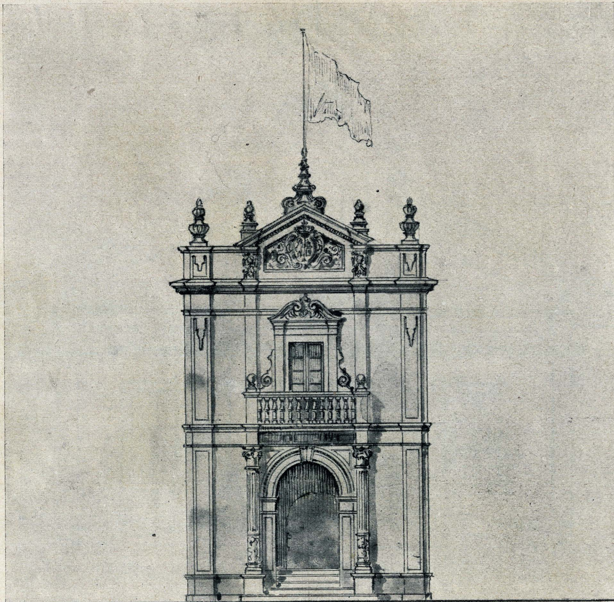
PROYECTO DE HABILITACION DE EDIFICIO PARA AYUNTAMIENTO DE ALCALA DE GUADAIRA FACHADA PRINCIPAL * ESCALA : 0,01 = 1M. 2
